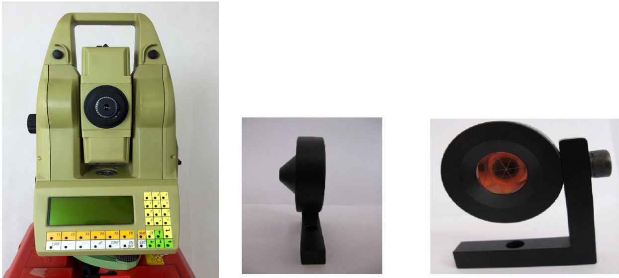
Рисунок 1 - Автоматизированный тахеометр Leica TCA 1800 и инни призма GMP 104
