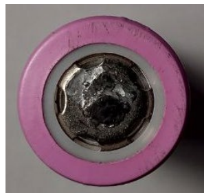
Рисунок 6 – Шар олова на «+» полюсі елемента
