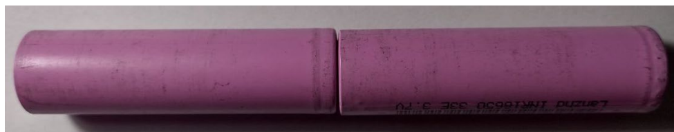
Рисунок 7 – Два Li-ion елемента з'єднані послідовно з олов'яною напайкою
