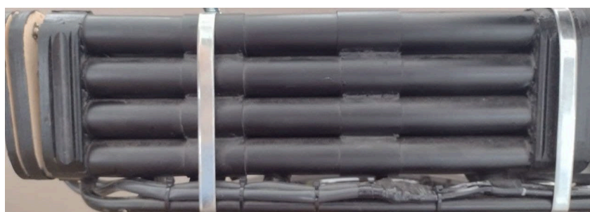
Рисунок 3 – Батарея на багажнику велосипеда, задня кришка надіта на шпильки та не притягнута
