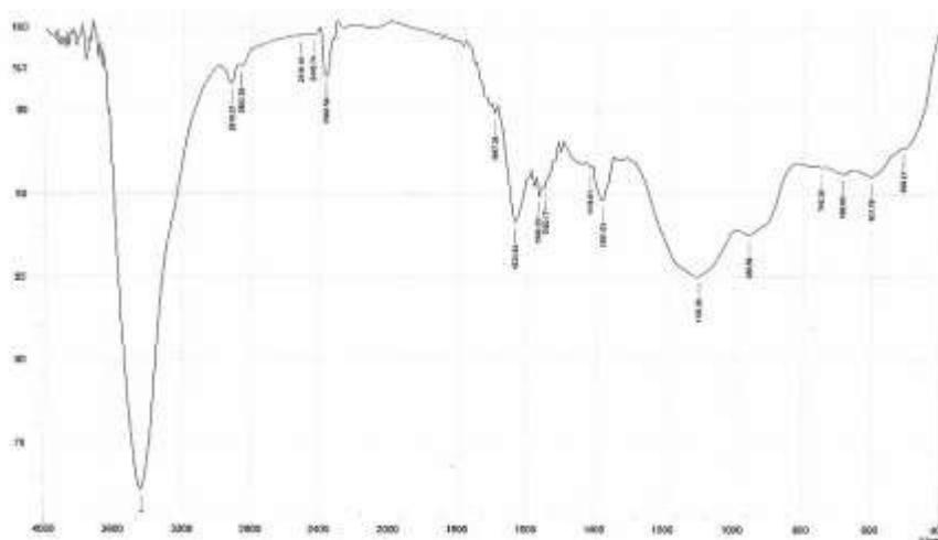
Рисунок 3. Спектри пропускання функціоналізованих МВНТ після кип'ятіння в розчині азотної кислоти (з масовою часткою 38%), час витримки 30 хв.
