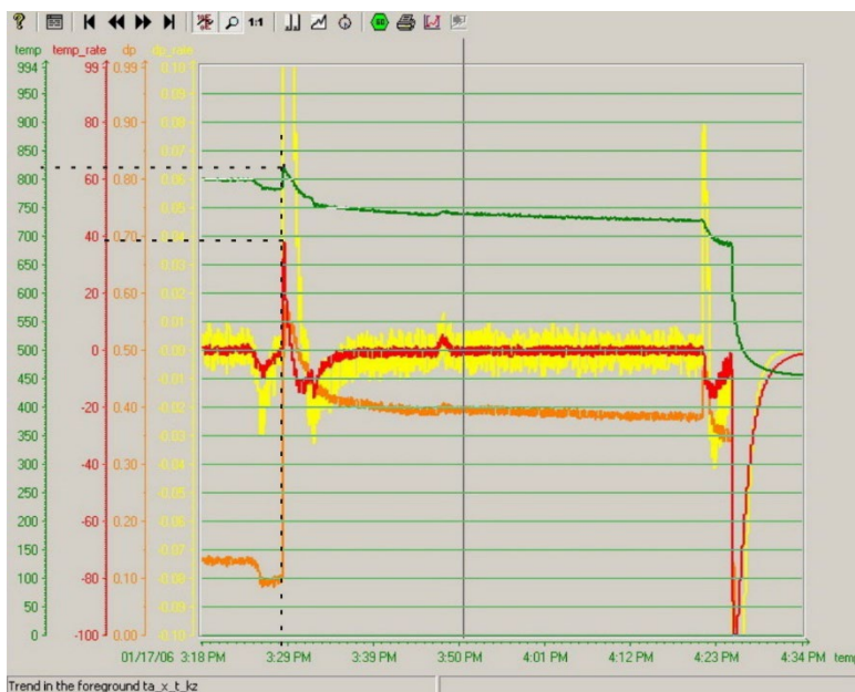
Рисунок 3 - Тренди SCADA системи під час зупинки ГПА
