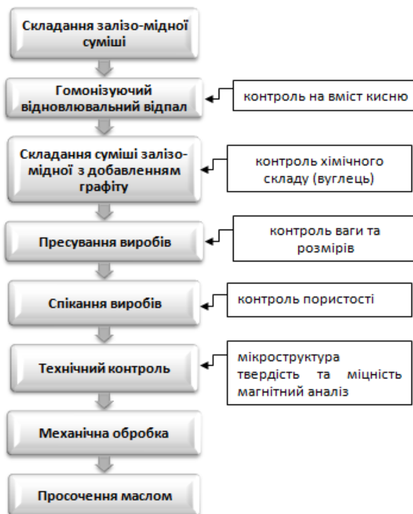
Рисунок 2 - Технологічна схема виготовлення спечених композиційних виробів
