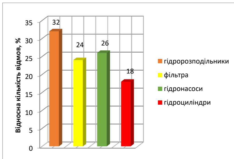
Рисунок 2 – Відносна кількість відмов гідроагрегатів (у % до загального числа відмов)
