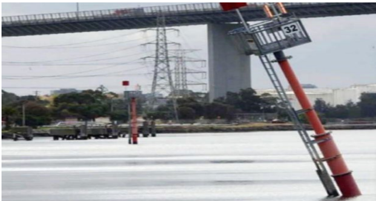
Рисунок 5. – Наслідки зіткнення контейнеровозу «PUCCINI» з навігаційним знаком в порту Мельбурн [4]
