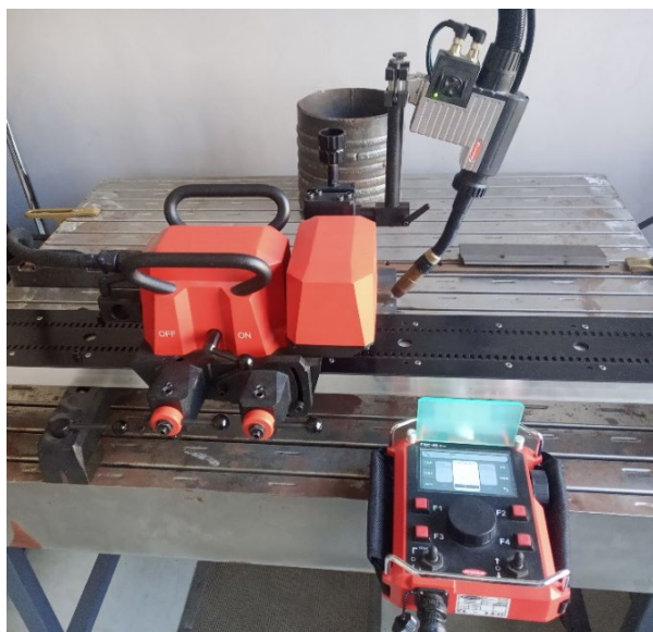
Рисунок 2 – Візок Fronius FlexTrack 45 Pro з пристроєм маятникового переміщення пальника FOU 30/ML10, пальником Robacta Drive CMT та пультом керування
