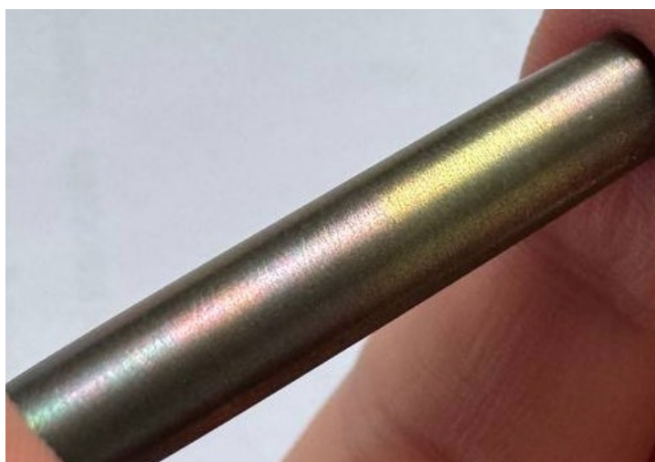
Рисунок 3 – Вигляд тонкого молібдатного покриття на цинковому електроді
