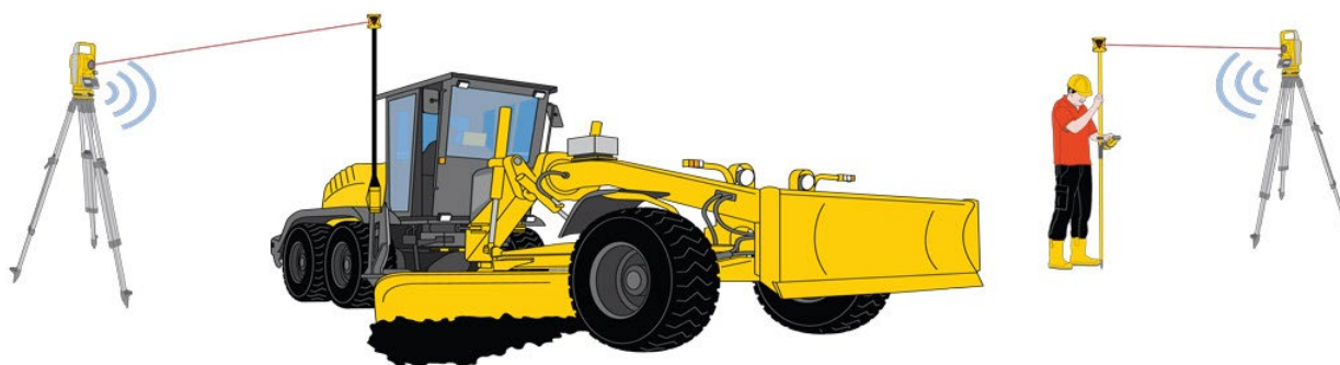
Рисунок 6 - Схема роботи технології 3D LPS [3]
