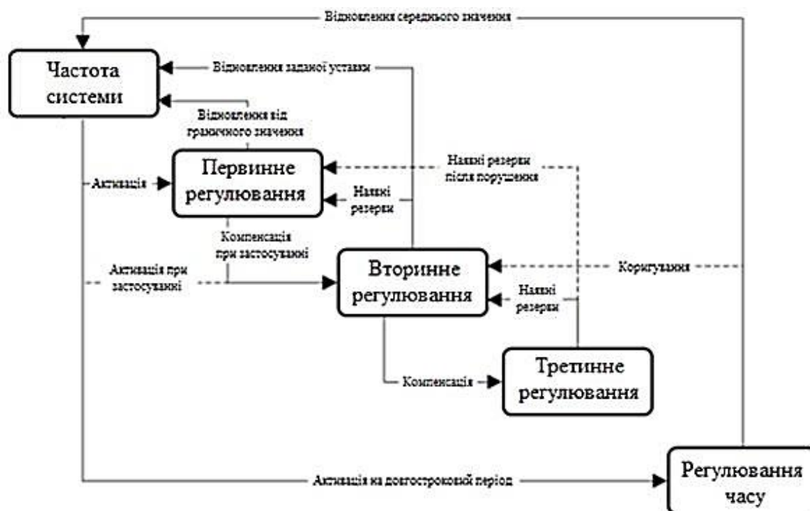
Рисунок 1 – Функціональна структура побудови системи регулювання частоти та потужності в ОЕС України
