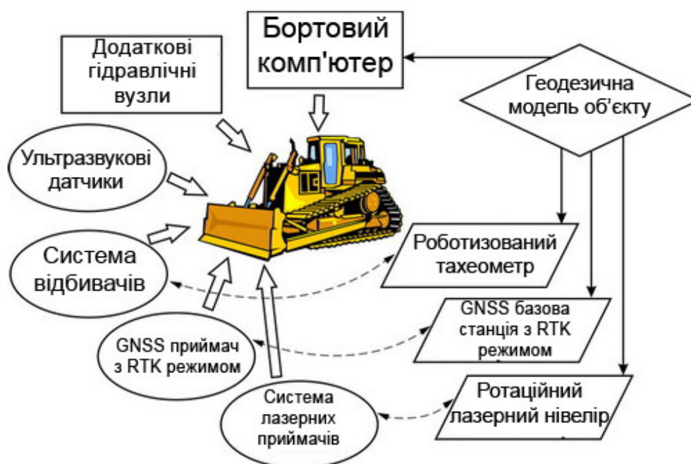
Рисунок 1 - Схема системи автоматичного нівелювання для грейдерів і бульдозерів [3]
